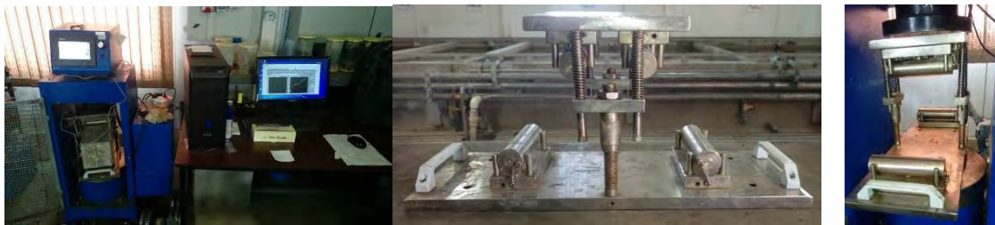
شکل ۵: دستگاه تست مقاومت خمشی تیر منشوری (بارگذاری ۴ نقطه‌ای)
