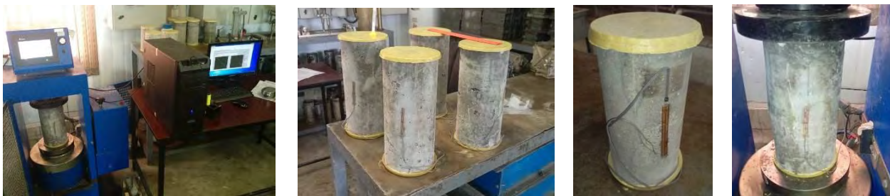
شکل ۴: کپی نگ نمونه های استوانه ای و نصب کرنش سنج های دیجیتال
