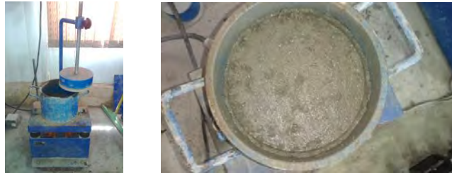
شکل ۳: دستگاه وی بی اصلاح شده و تشکیل رینگ کامل شیره ی بتن مطابق دستورالعمل اجرای آزمایش
