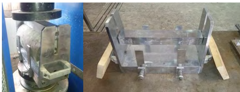
شکل ۶: دستگاه مقاومت کششی برزیلی و نحوه‌ی استقرار دستگاه و انجام آزمایش
