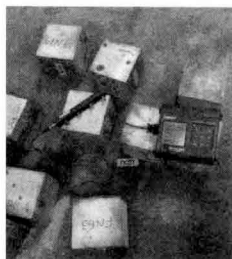
شکل ۶- آزمایش مقاومت الکتریکی ویژه
